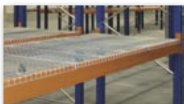
Platelage posé en grillage avec support
