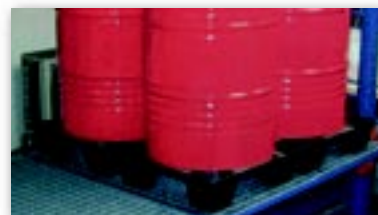
Bacs de rétention
